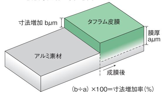
タフラム皮膜は、硬くて機械強度に優れマイクロクラック等の微細凹凸に富んだ硬質アルマイトに、厳選された微小なフッ素樹脂をタフラムプロセスにて複合した皮膜です。皮膜は硬質アルマイトとフッ素樹脂のシナジー効果を発揮させた高機能複合皮膜で、耐摩耗性向上・摺動性向上・かじり防止・スティックスリップの減少等の特長を持ちます。また、電気絶縁性・離型性・耐食性等の特性を有します。また、皮膜は均一であり、精度を要求される部品にも対応が可能です。
