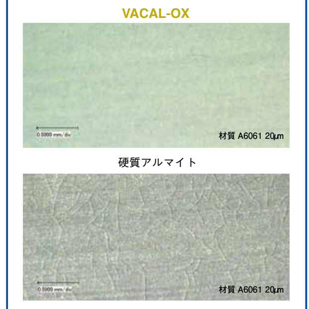
熱負荷後表面拡大写真 (400°C 2 時間加熱)
