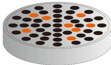
ブレイカープレートはシリンダー内で発生する溶融樹脂の未溶融・炭化物・ゲル状物などの異物除去のために装着しますがニダックスを施工すると、その内径部の耐摩耗性と離型効果により清掃が容易に行えます。
